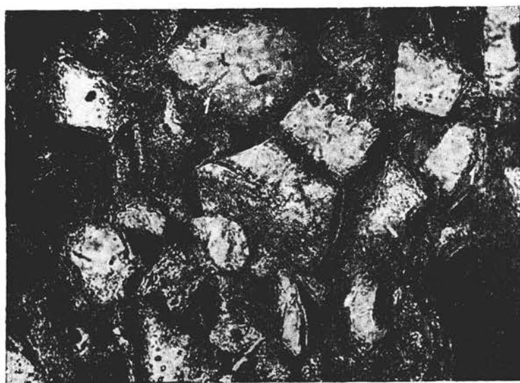
Фиг. 2. Реакционная кайма разъедания вокруг зерен кварца. Глубина 37,20 м. Шлиф 21. Николи +. Увел. 290
