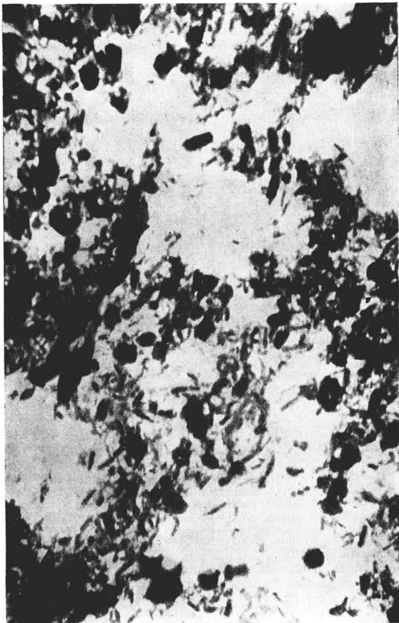
Фиг. 27. Разложенный серпентит (обр. № 110а). Электронный микроскоп. Увел. 24 000 (снято Б. Б. Звягиным).
