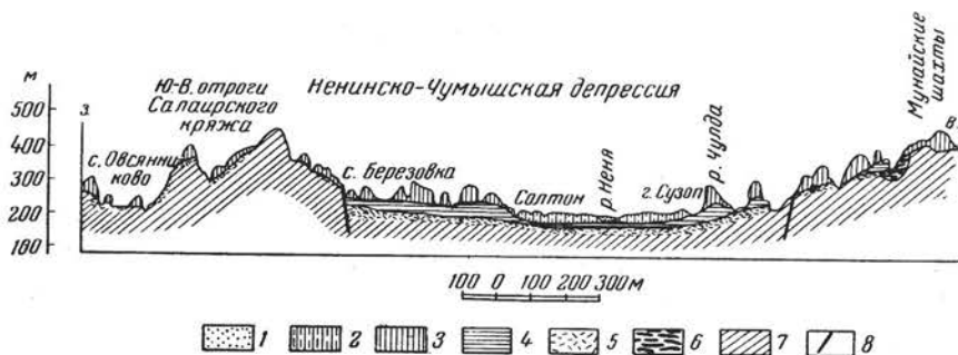
Фиг. 3. Схематический разрез через Ненинско-Чумышскую впадину, вскрывающий условия залегания древней коры выветривания в горно-холмистых предгорьях
