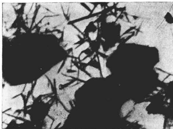
Фиг. 4. Каолинит с примесью галлузита. Электронная микрофотография
