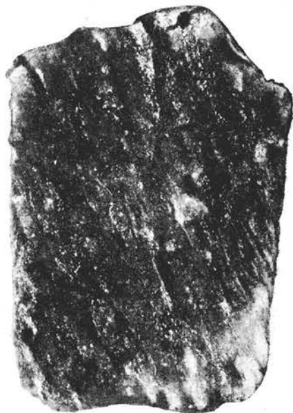
Фиг. 5. Мигматитовый гнейс. Характер кристаллического фундамента Калужского разреза. Фото зерна (1/2 нат. вел.)
