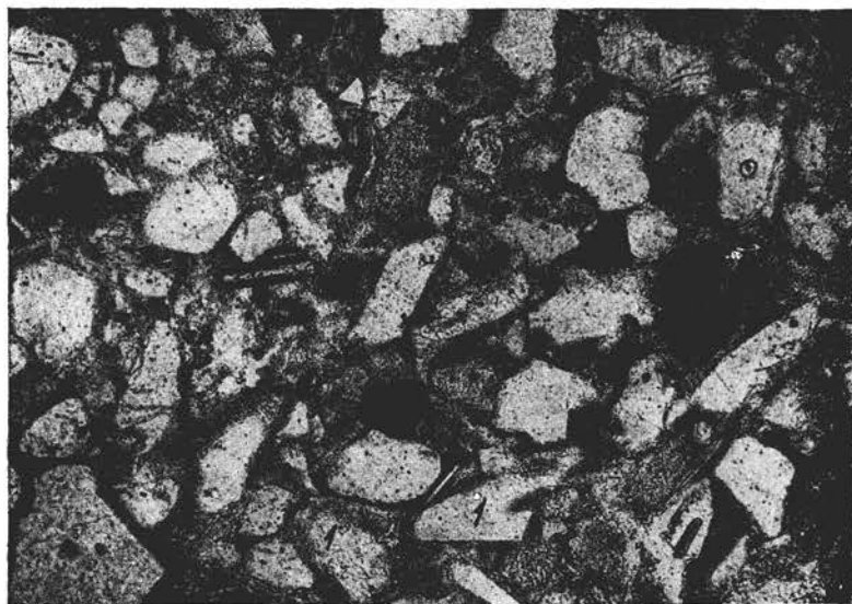
Фиг. 4. Образование глубоких заливов при разъедании кварца (I). Глубина 30,00 м. Шлиф 38. Николи ||. Увел. 90
