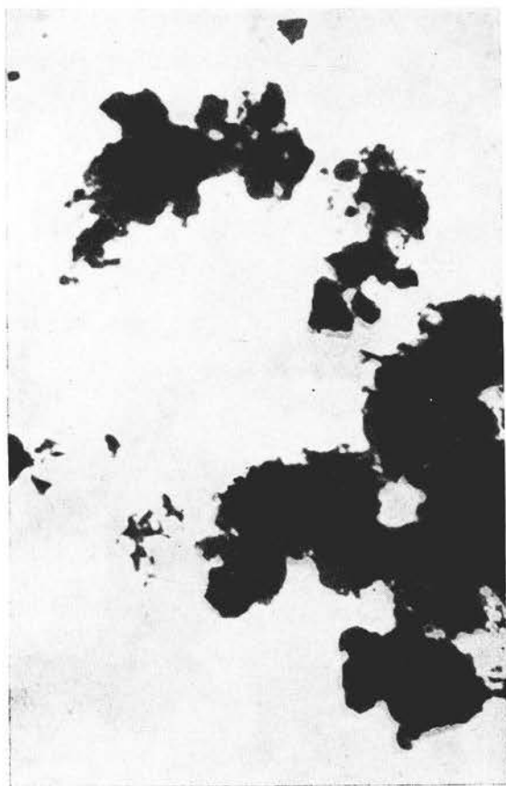
Фиг. 26. Продукты выветривания серпфита (обр. № 31). Электронный микроскоп. Увел. 28 000 (снято Е. С. Рудницкой)
