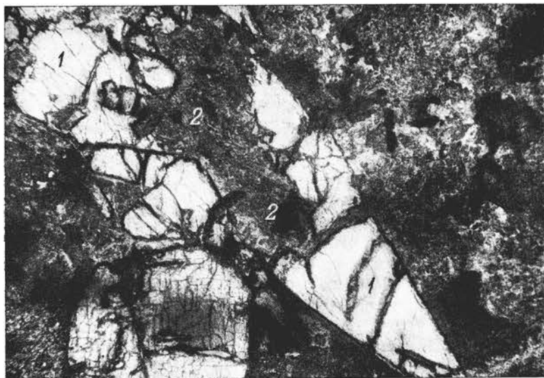
Фиг. 4. Скопление монтмориллонита в зернах аксинита (обр. № 29). Николи ||. Увел. 46
