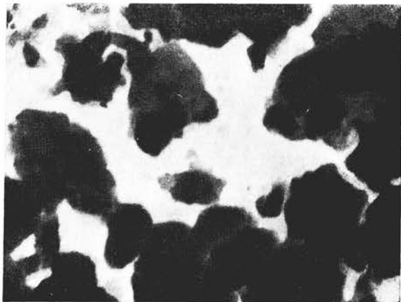
Фиг. 1. Форма частиц фарфоровидного каолинита. Электронная микрофотография. 1
