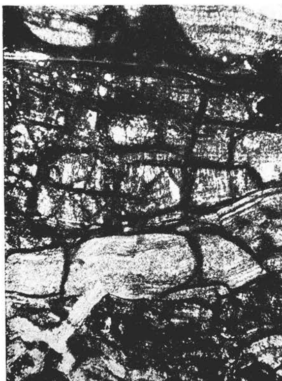
Фиг. 2. \alpha -керолит колломорфной структуры. Тонкие черные прожилки — опал. Шлиф 100. Николи +. Увел. 90
