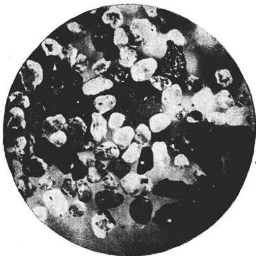
Фиг. 5. Минерал глин среди зерен кварца и полевого шпата (фракция 0,25—0,50 мм) в иллювиальном горизонте. Увел. 50
