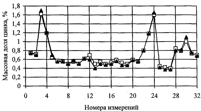
Рис. 6.15. Результаты сравнительных испытаний анализатора РА-931 на хвостах цинковой флотации на Учалинской ОФ:
