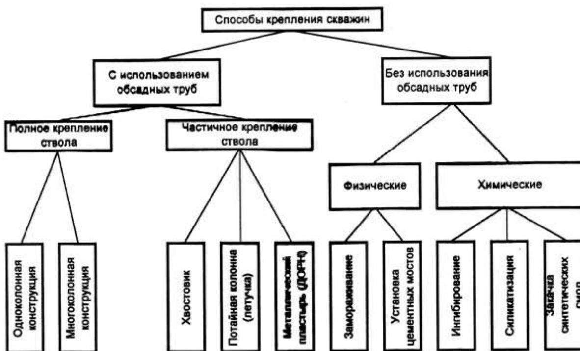
Рис. 3.1. Классификация способов крепления нефтяных и газовых скважин.
