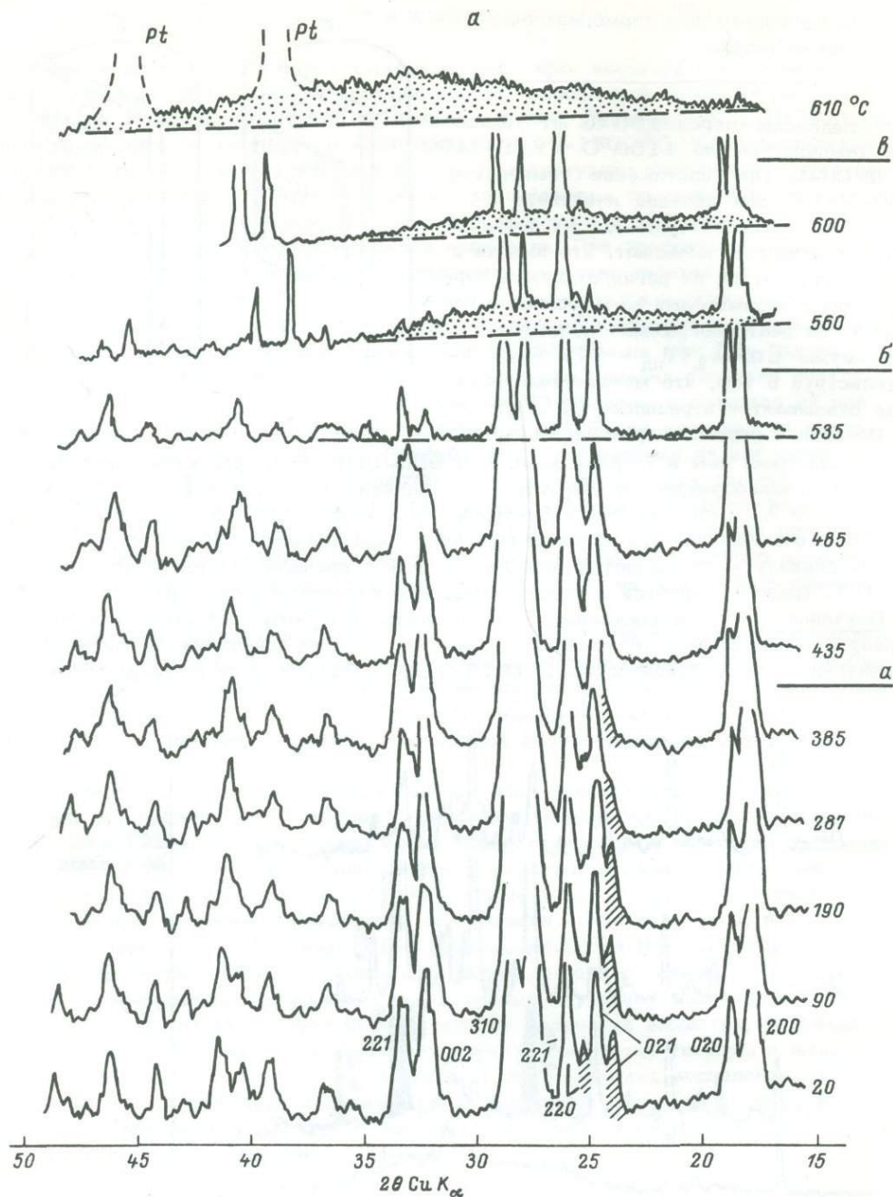
Рис. 3. Дифрактограммы (а) и диаграмма состояния (б) системы \text{Na}\alpha\text{NaV}_2\text{O}_6 - \text{KNaV}_2\text{O}_6 : фаза \alpha обогащена \text{Na}\alpha в \text{M}_2 , \beta - К (Бубнова и др., 1983).
