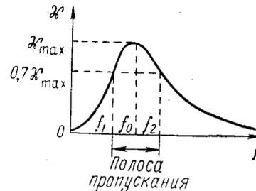
Рис. 108. Частотная характеристика линейного регистрирующего аппарата
