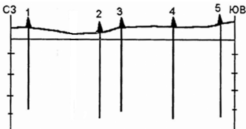
Рис. 9.1. Построение рамки разреза и нанесение скважин
