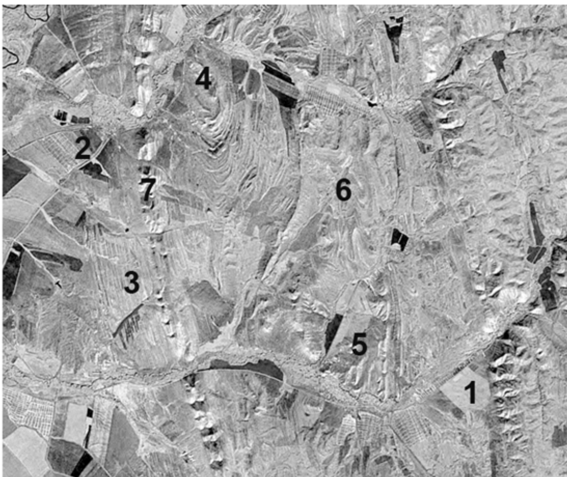
Рис. 12.1. Монохромное изображение и развитые на нем типы фоторисунка: 1 - гладкий, 2 - угловато-мозаичный, 3 – прямолинейно – полосчатый, 4 – округло-полосчатый, 5 – прерывисто-полосчатый, 6 - извилисто-полосчатый, 7 -угловато-пятнистый
