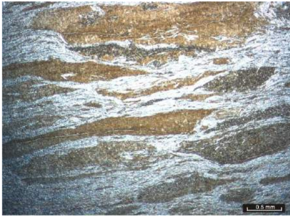
Рис. 4.17. Литогенетический тип В. А - Глинистая доломит-ангидритовая, глубина 1732,68 м, николи //; Б - Ангидрит-доломитовая порода, глубина 1683,46 м, николи Х.
