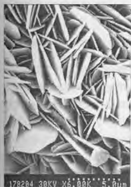
Рис. 3.6. Упорядоченное распределение пластинчатых чешуек хлорита в цементе песчаника свидетельствует об аутигенном генезисе этого минерала (на одной из постседиментационных стадий). Фотографии скола в растровом электронном микроскопе
