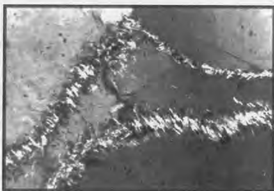
Рис. 3.7. Шиповидные вроски аутигенной слюды (белые «иголочки») в края обломочных кварцевых зерен в метапесчанике (Симанович, 1978). Шлиф, поляризационный микроскоп, николи скрещены; длина по горизонтали – 0,25 мм
