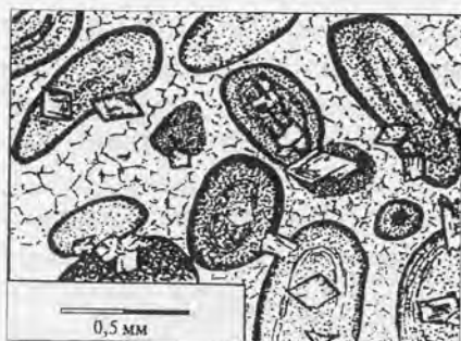
Рис. 3.8. Метасоматическая доломитизация оолитового известняка среднего девона в Южном Марокко. Зарисовка шлифа Дж. Гринсмитом (1981). Аллотигенные оолиты сцементированы кристаллически зернистым аутигенным кальцитом (диагенетической стадии). Более поздние новообразования – ромбоздры доломита, заместившего кальцит в оолитах и цементе. Свидетельство – секущие границы ромбоздров с прочими породообразующими компонентами
