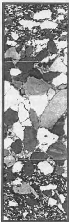
Рис. 3.4. Растворение (вверху и внизу) и регенерация (в середине) обломочного кварца в песчанике на стадии глубинного катагенеза (Симанович, 1978). Шлиф, николи скрещены; размеры обломочных зерен от 0,25 до 0,5мм
