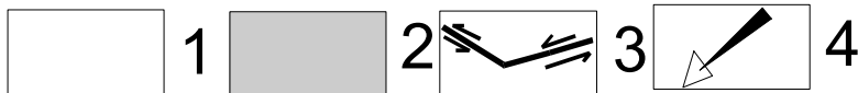
Рис. 1 . Моделирование микрзоны сжатия со сдвигом на каолине [161]. 1-области сжатия, частицы каолина в которых ориентированы примерно перпендикулярно основному сжатию; 2 - области сдвига и растяжения, частицы каолина примерно параллельны основному сдвигу, длинной оси рисунка; 3- разрывы; 4- направление внешнего сжатия
