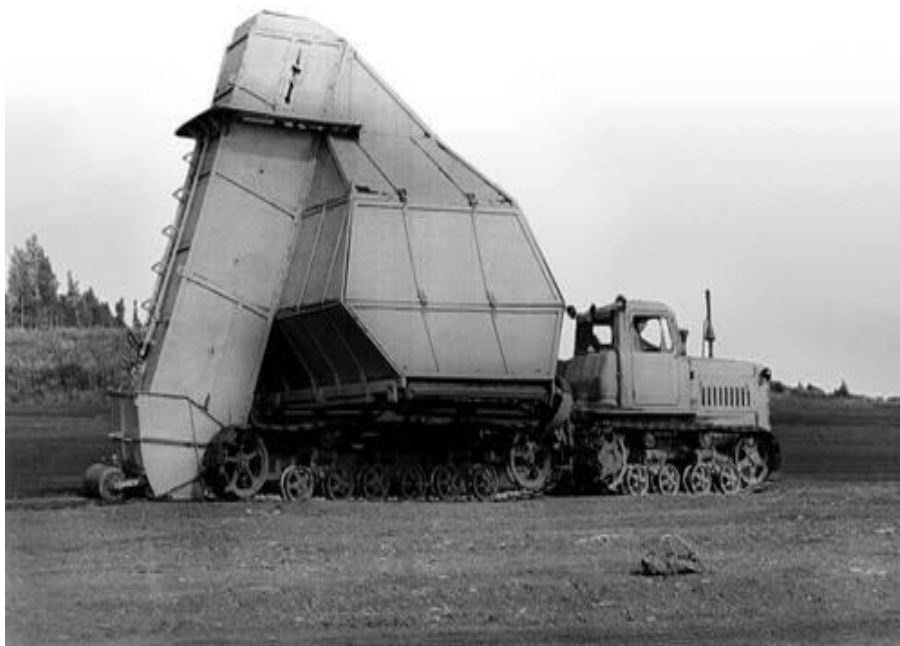
Рис. 4.1. Бункерная уборочная машина УМПФ с рабочим органом скреперного типа
