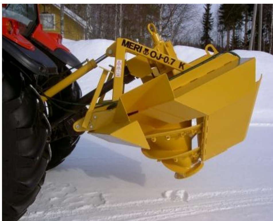
Рис. 2.17. Рабочий орган шнекового (фрезерного) каналокопателя
