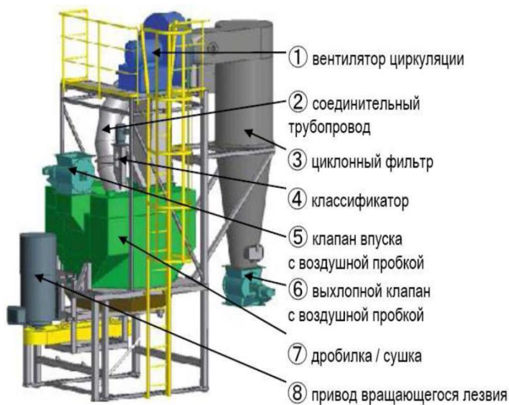
Рис. 2.11. Кинетически-тепловой измельчитель KDS Micronex
