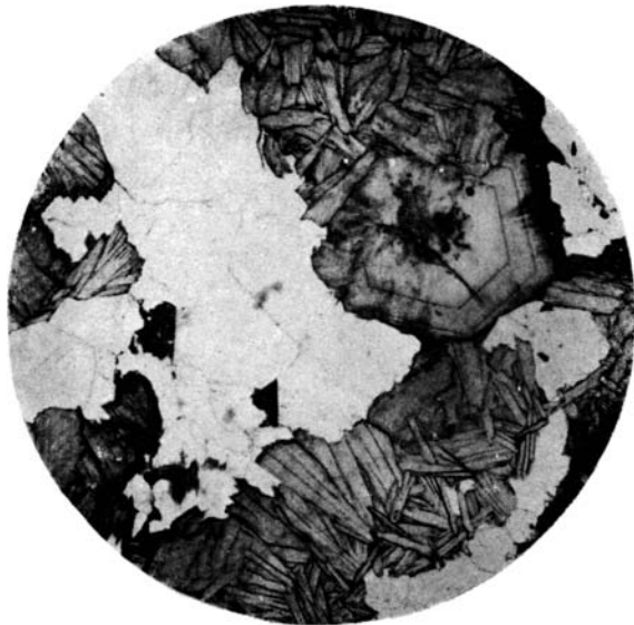
Ф и г. 25. Зональное строение железистого хлорита.
