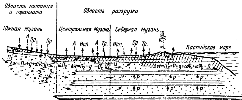
Рис. 21. Схема структуры водного баланса Муганской равнины: \Delta w — изменения запасов грунтовых вод; A — атмосферные осадки; Or — оросительные воды; Исп — испарение; Тр — транспирация; О — подземный отток; П — подземный приток; +g — инфильтрационное питание грунтовых вод за счет атмосферных осадков (Южная, Центральная Мугань), инфильтрации на орошаемых полях (Южная, Северная Мугань); \alpha Фк — питание грунтовых вод за счет фильтрации из каналов и \alpha Ф — р. Куры; Д — дренажный сток; Р — напорное питание грунтовых вод
