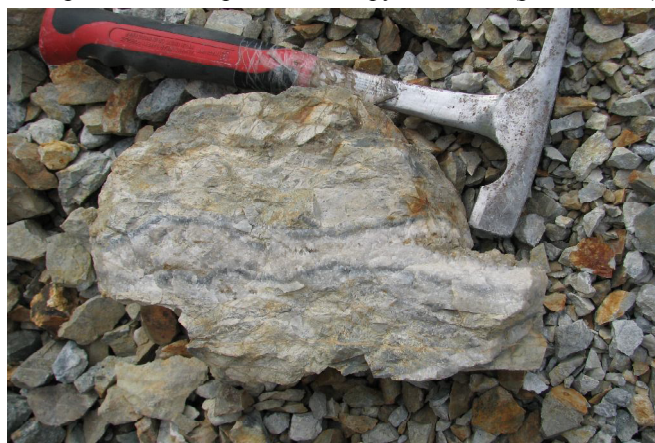
Рис. 4.3. Жила полосчатого рудоносного кварца в аргиллизированных и пиритизированных песчаниках из зоны «Бахмут» месторождения «Пионер» (фото А.В. Мельникова).
