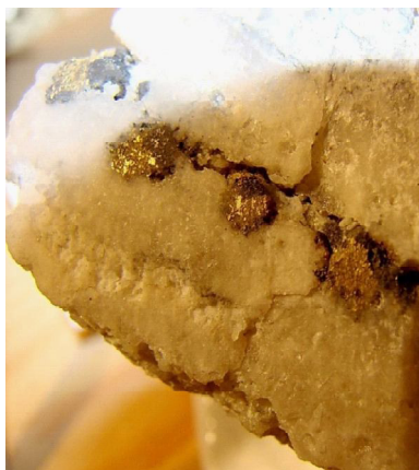
Рис. 4.5. Слева – видимое золото месторождения «Пионер» в кварце, размер золотинок 0.5-1 мм; справа – формы выделений золота (протолочка), размер золотинок 0.02-1.5 мм. Фото А.Е. Казанцева.
