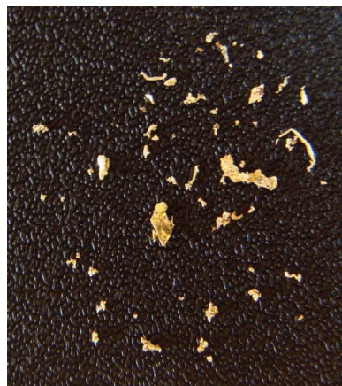
Рис. 4.5. Слева – видимое золото месторождения «Пионер» в кварце, размер золотинок 0.5-1 мм; справа – формы выделений золота (протолочка), размер золотинок 0.02-1.5 мм. Фото А.Е. Казанцева.
