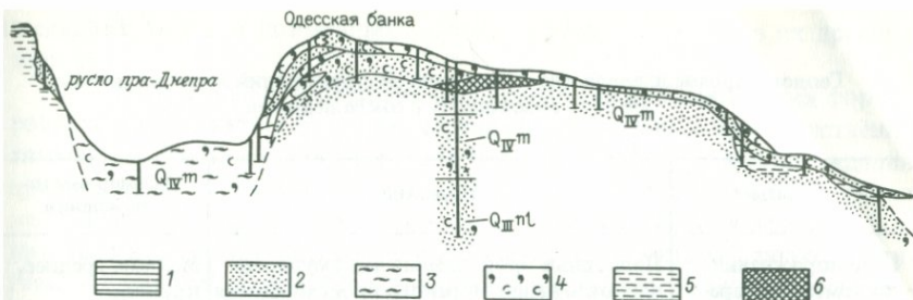
Рис. 5. Геологический разрез месторождения песков Одесская банка. По Л.Б. Розовскому.
