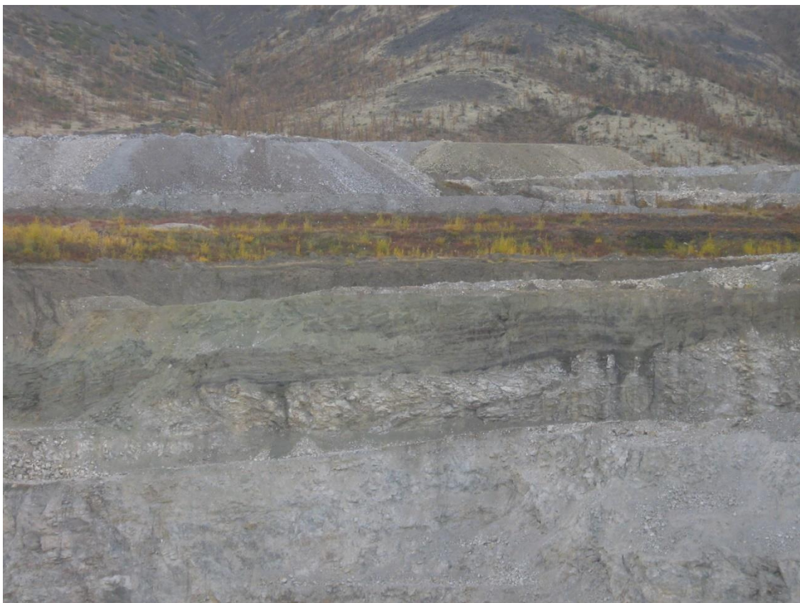
Рисунок 5-16. Контакт рудовмещающей гурникской свиты и перекрывающей корбинской в стенке карьера месторождения Биркачан
