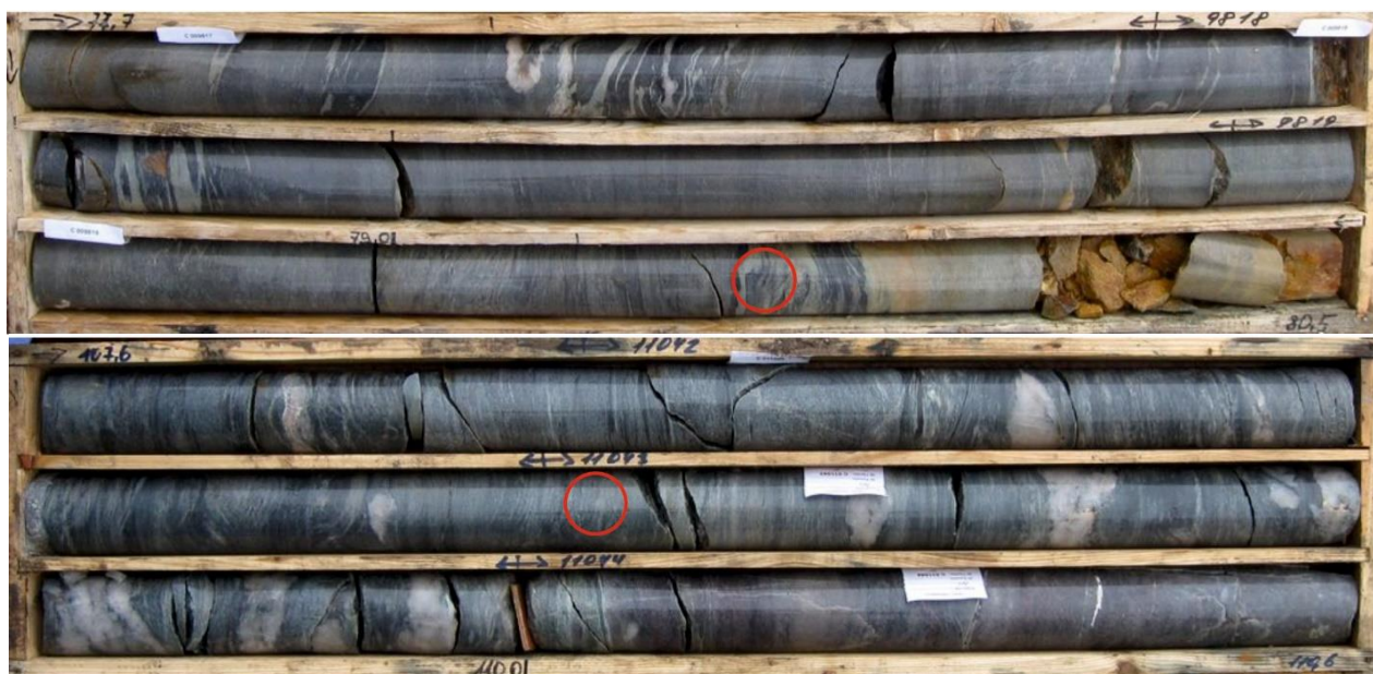
Рисунок 4-15. Дорудные «альпийские» кварцевые прожилки в кварц-серицитовых сланцах. Месторождение Надежда, скважины ND11-009 (вверху) и ND11-011 (внизу)
