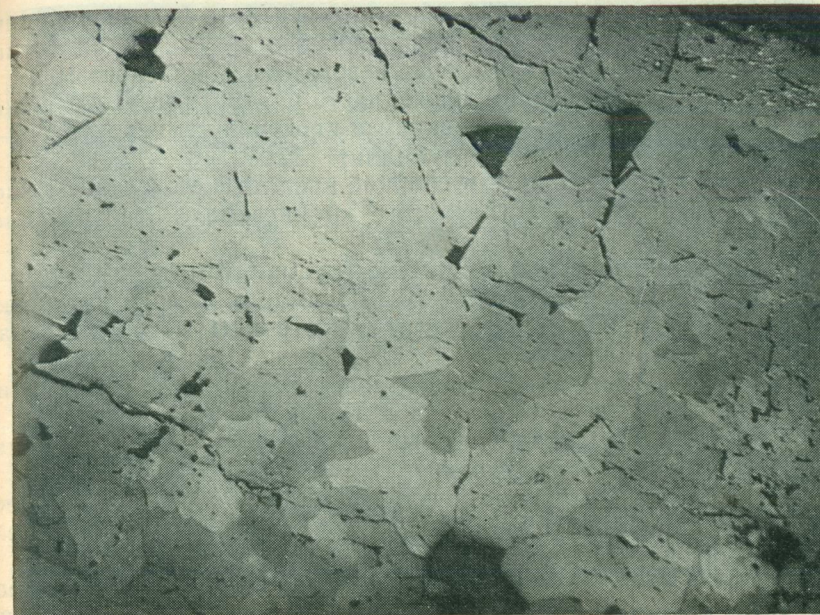
Фиг. 6. Агрегат кристаллических зерен браунита аллотриоморфной структуры. Полированный шлиф. Николи +. Увел. 90
