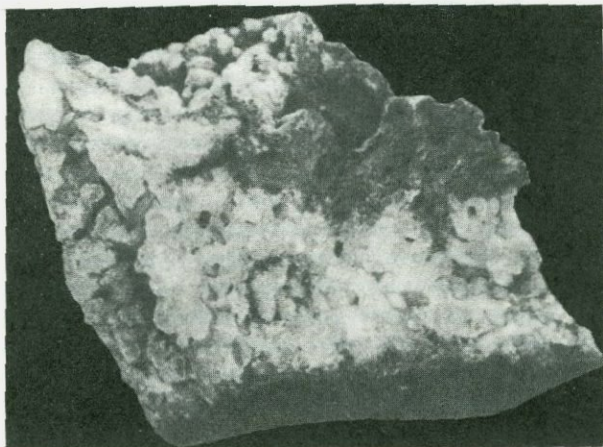
Фиг. 18. Крупное зерно шеелита, окаймленное оторочкой хлорита с редкой вкрапленностью касситерита, в жиле раннего оловоносного кварца. На контакте с вмещающей породой каемка хлорита и касситерита. Силинское месторождение. Штуф из жилы Балаганной. 1/2 н.в.
