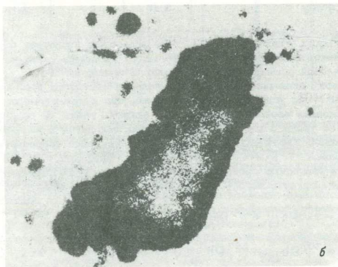
Рис. 3. Распределение урана в измененных кристаллах биотита. а - фотография шлифа; б - радиография: повышенное содержание урана приурочено ко вторичным минералам.
