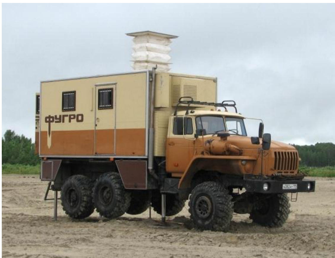
Рис.35. Установка статического зондирования.
