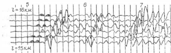
Рис. 41. Сейсмограмма зондирования при изучении поверхности фундамента Западно-Сибирской плиты. В первых вступлениях — преломленная волна от поверхности фундамента; в последующей части записи — волны от границ в осадочном чехле.
