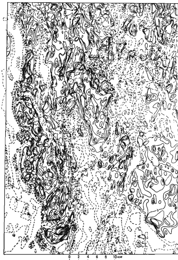
Фиг. 7. Магнитная карта. Сложный мозаичный рисунок магнитного поля, характерный для блоковой структуры средней части Тагильского синклиория (Павдинский район, Средний Урал. Выкопировка из магнитной карты Урала, составленной под редакцией Е. М. Ананьевой).
