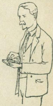
Рис. 33. Положение горного компаса при определении азимута.
