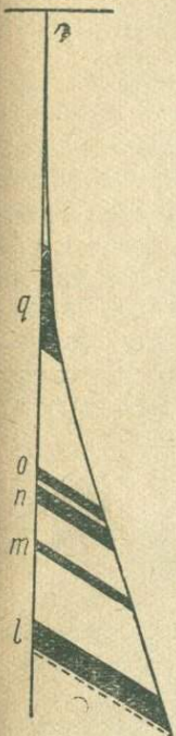
Рис. 134. Неправильная мощность в искривленной скважине.
