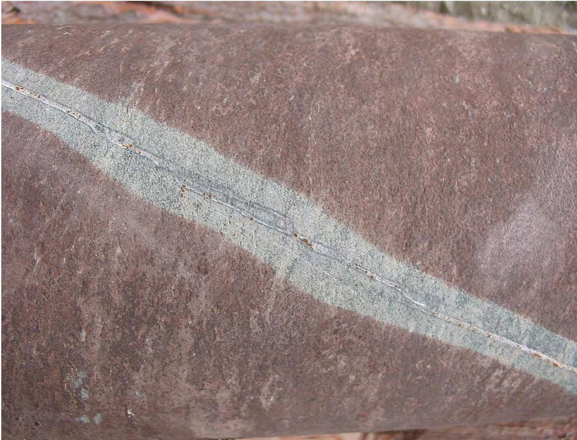
Прожилковое осветление в экзоконтакте кимберлитов Ботубинской трубки. Разведочная скв. Б-8-6Д, глубина 555,5 м. Толщина прожилка 2 см
