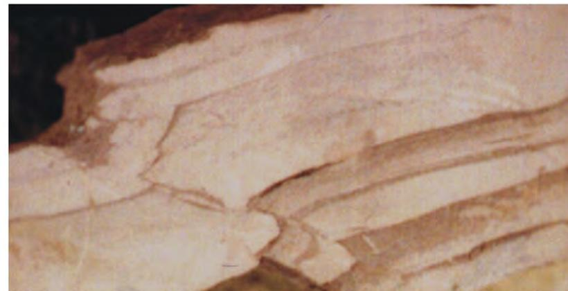
Вязко-пластические деформации и пологие микровзбросы в зоне влияния Диагонального разлома на юго-западном фланге Ботубинского месторождения, фото, уменьшено в 2 раза.
