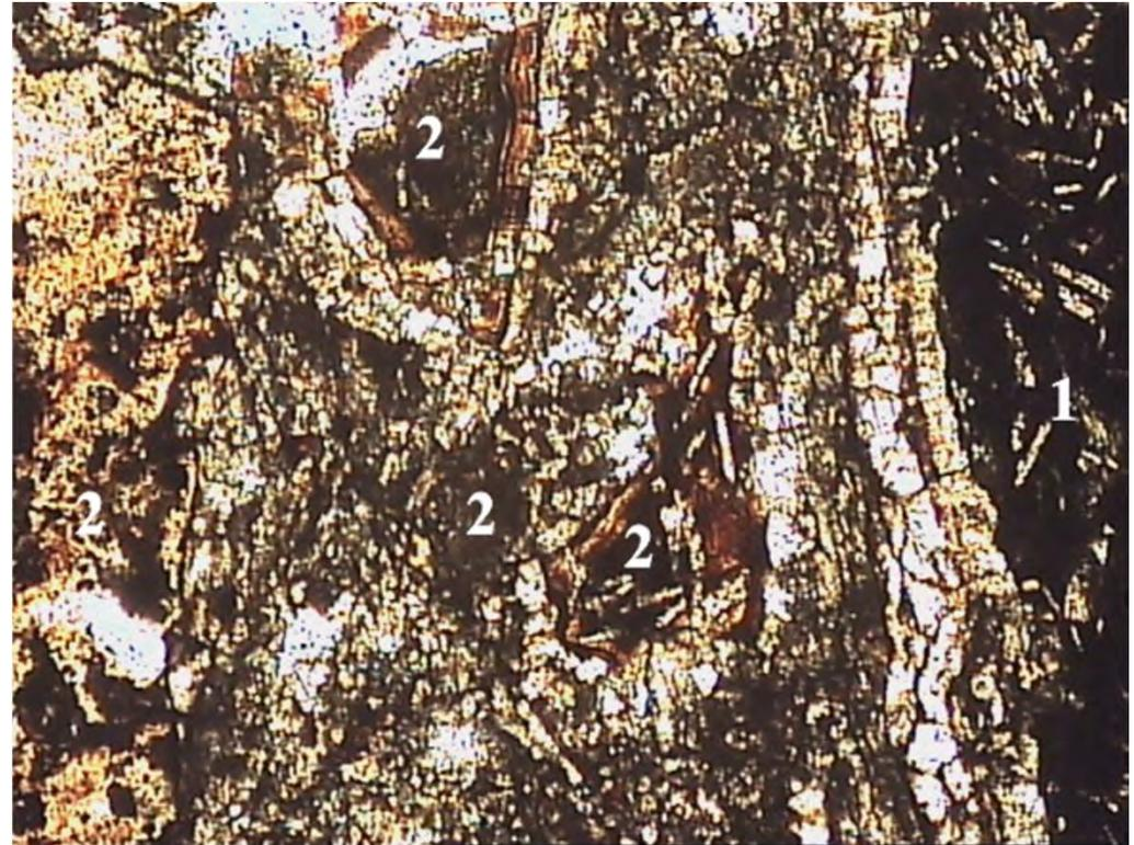
Остроугольные обломки долеритов (1) с кальцитовыми оторочками и вулканического стекла (2) с каймами гематитизации расположены в хлорит-карбонатном цементе. Фото прозрачного шлифа ув. 30х, николи ||, обр. из скв. 562-438/6 с глубины 125,5 м.
