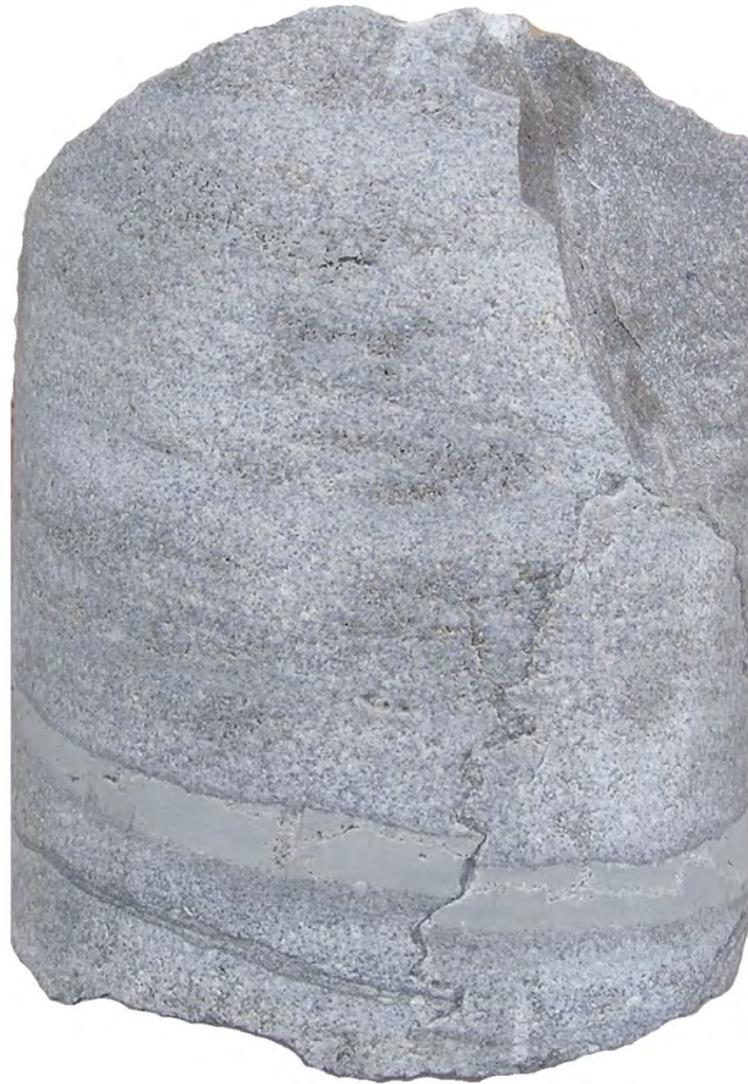
Рис. Ассоциация нарушений, сформированных в условиях горизонтального сжатия. Микровзброс и сутуро-стилолитовый шов по поверхности сместителя. Мархинское месторождение, керн наклонной скважины М-26 глубина 219 метров. Диаметр керна 112мм.
