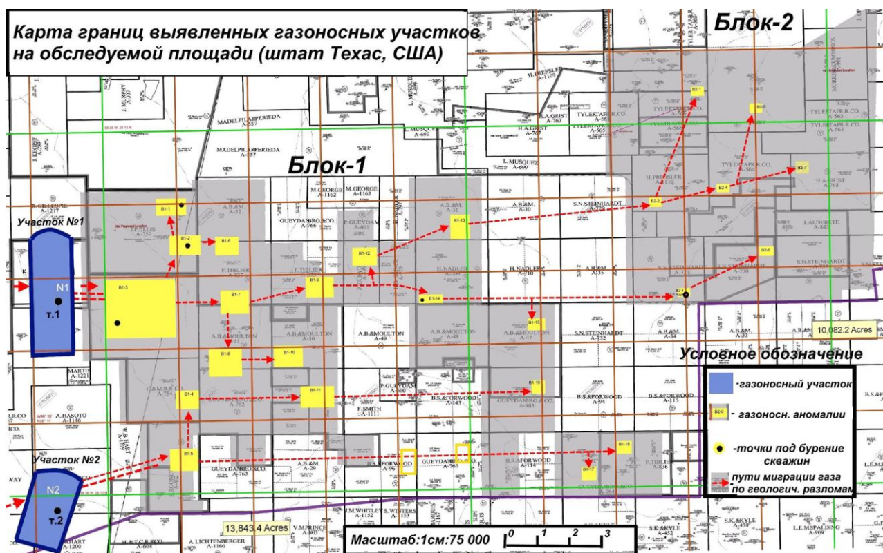
Рис. 9. Выявленные аномальные зоны типа «залежь газа» с помощью комплекса «Поиск» на лицензионном участке (США, штат Техас) [18]
