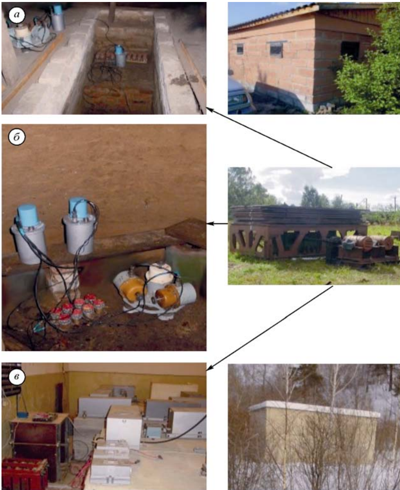
Рис. 2.4.4. К характеристикам условий возбуждения (вибратор ЦВП-40 на Быстровском полигоне) и приема (павильоны «Матвеевка» (а), «Крохалевка» (б) и «Ключи» (в)) при режимных вибросейсмических наблюдениях.
