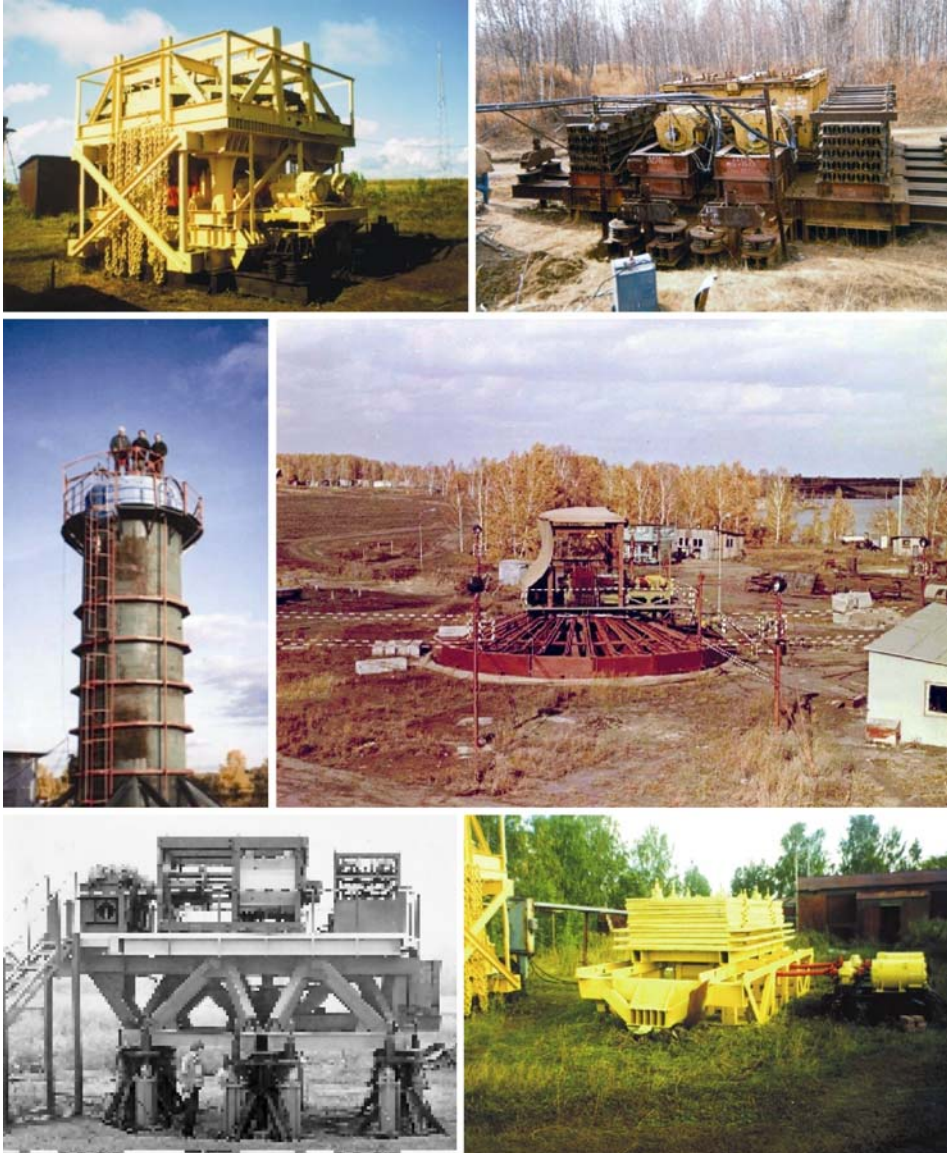
Рис. 2.1.1. Сейсмические вибраторы, созданные в Сибирском отделении АН СССР.
