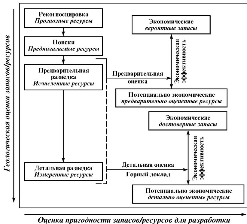
Рис. 8.1. Схема кодификации рамочной классификации ООН
