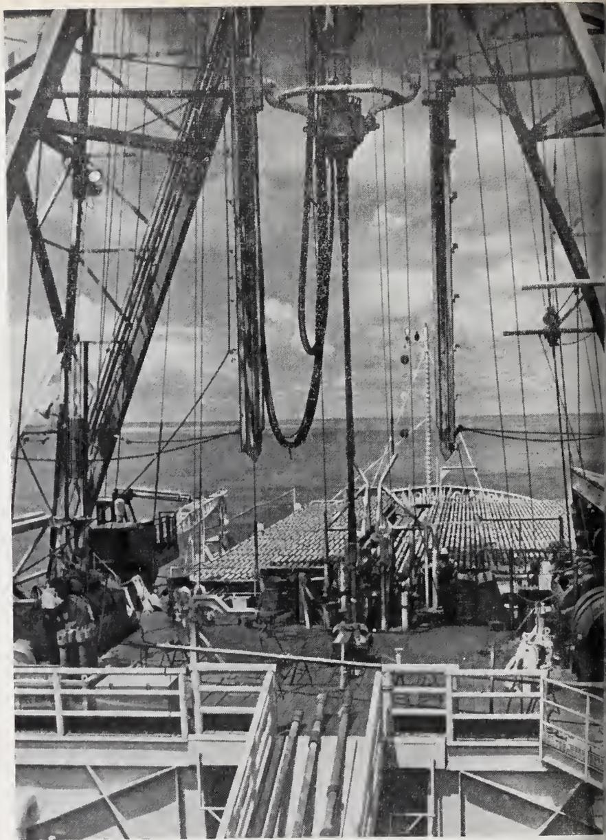
Рис. 4. Буровая установка «Гломар Челленджера». Носовая часть корабля буровыми трубами
