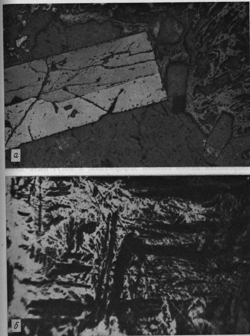
Рис. 7.16. a — двойник роста вольфрамита; b — полисинтетическое двойникование, развивающееся в синтетическом акантите, образовавшемся путем превращения из аргентина при охлаждении от 400^\circ\text{C} (температура первоначальной кристаллизации). Николи скрещены; масляная иммерсия (ширина поля зрения 190 мкм).
