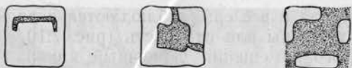
Рис. 7.12. Различные стадии в развитии атолловой структуры, возникающей при избирательном замещении кристаллов, представленных сростаниями или зонами различного состава.
