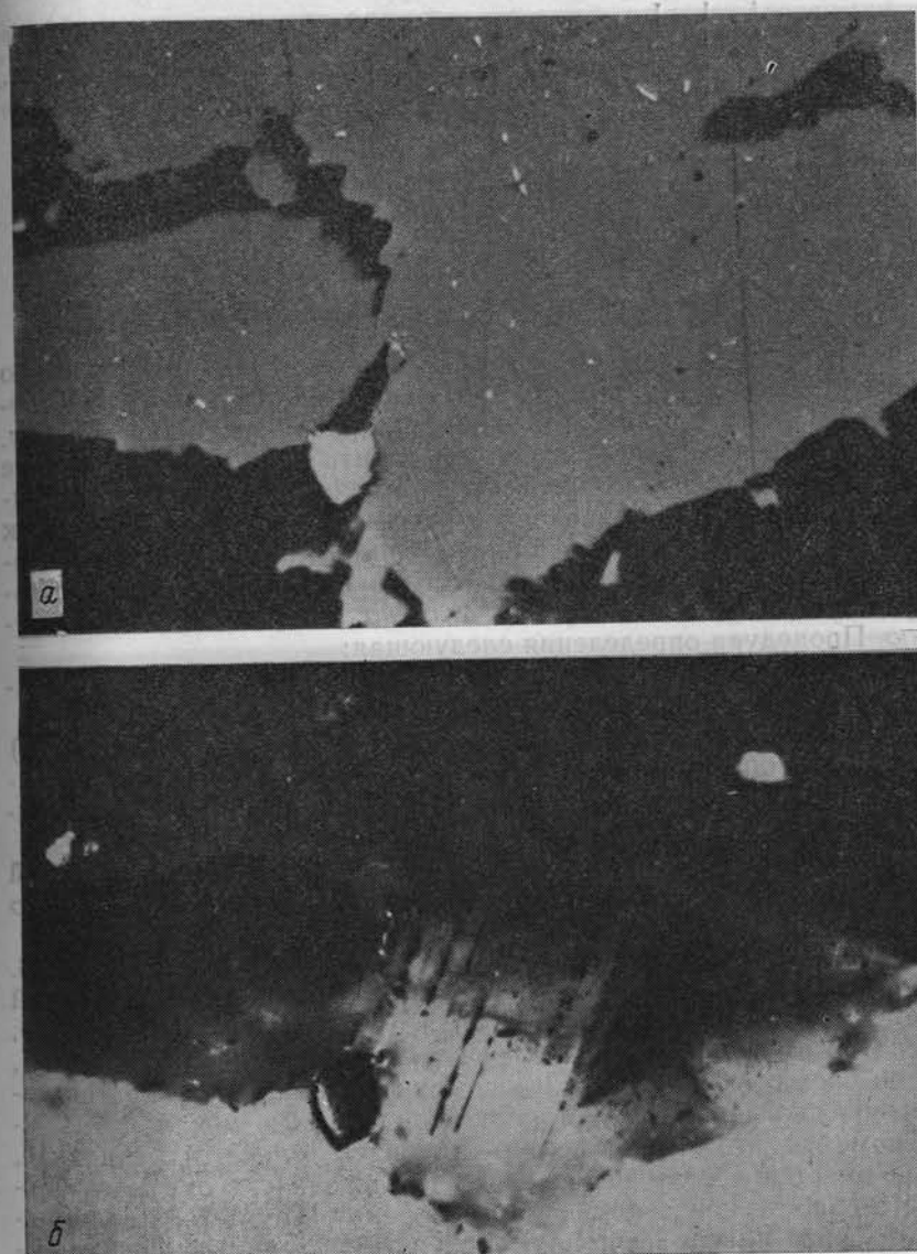
Рис. 3.2. Внутренние рефlekсы в сфалерите: а — сфалерит, содержащий включения халькопирита, сфотографирован в линейно или «плоскополяризованном» свете; б — то же зерно, сфотографированное в скрещенных николях. Характер отражения от поверхности, а следовательно, изотропная природа минерала искажаются интенсивными внутренними рефlekсами (ширина поля зрения 520 мкм).
