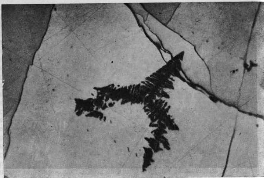
Рис. 7.25. Сфалеритовая «звездочка» в халькопирите. Минерал-Дистрикт, Виргиния (ширина поля зрения 330 мкм).
