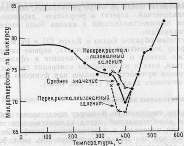
Рис. 6.5. Мягчение — твердение, сопровождающие процессы регенерации — перекристаллизации природно деформированного галенита из Брокен-Хилла, Австралия. Образцы нагревались в течение одного дня, и нанесенные на диаграмму величины представляют собой среднее значение из 70 вдавливаний (из книг Вогана и Крейга [8], Стентона и Уилли [6]; воспроизведено с разрешения авторов).
