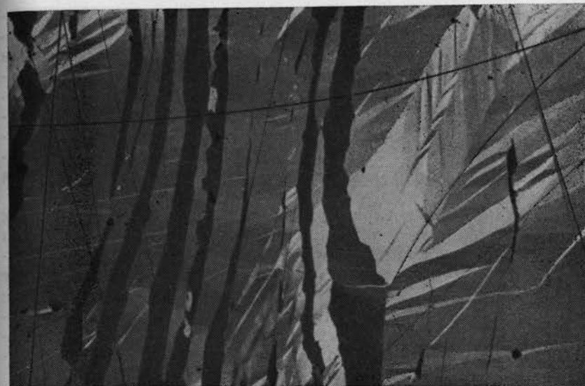
Рис. 7.18. Сложные пластинки давления, образовавшиеся в антимоните в результате деформации; большое разнообразие окрасок обусловлено различной кристаллографической ориентировкой пластинок. Николи скрещены (ширина поля зрения 520 мкм).
