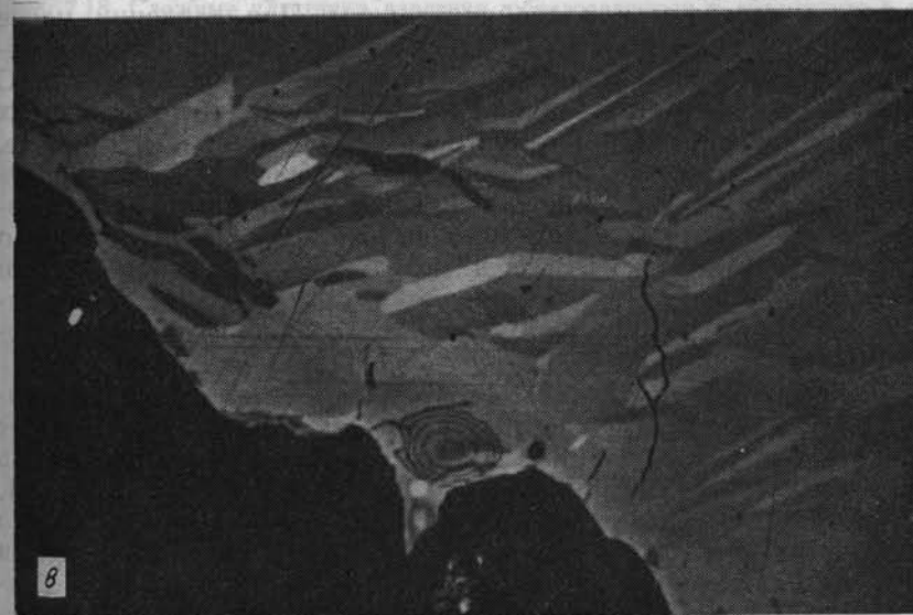
Рис. 7.17. а — двойники деформации в пирротине, Грейт-Госсан-Лид, Виргиния. Николи скрещены (ширина поля зрения 520 мкм); б — полисинтетическое двойникование, развивающееся в самородном висмуте, в результате деформации. Ниписсинг-Майн, Кобальт, Онтарио. Николи скрещены; масляная иммерсия (ширина поля зрения 210 мкм); в — полосчатость изгиба, образовавшаяся в пирротине в результате деформации, Грейт-Госсан-Лид, Виргиния (ширина поля зрения 700 мкм) (по D. K. Henry et al., Econ. Geol., 74, 648, 1979; использовано с разрешения авторов).
