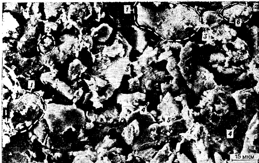
Рис. 5.7. Фотомонтаж РЭМ-изображений образца озерного суглинка IQ 3 (пос. Табрат) со скелетной микроструктурой
