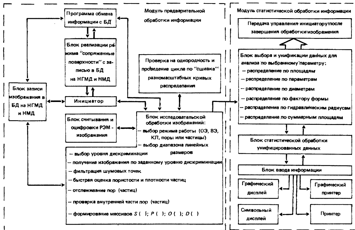
Рис. 4.14. Алгоритм проведения количественного анализа микроструктуры по РЭМ-изображениям
