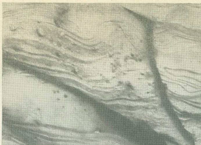
Рис. 4. Слоистая субструктура самородного золота. Микрослоистое строение с выходом штрихов скольжения и признаками микроступенчатости и внутренних деформаций. Увел. 7000.
