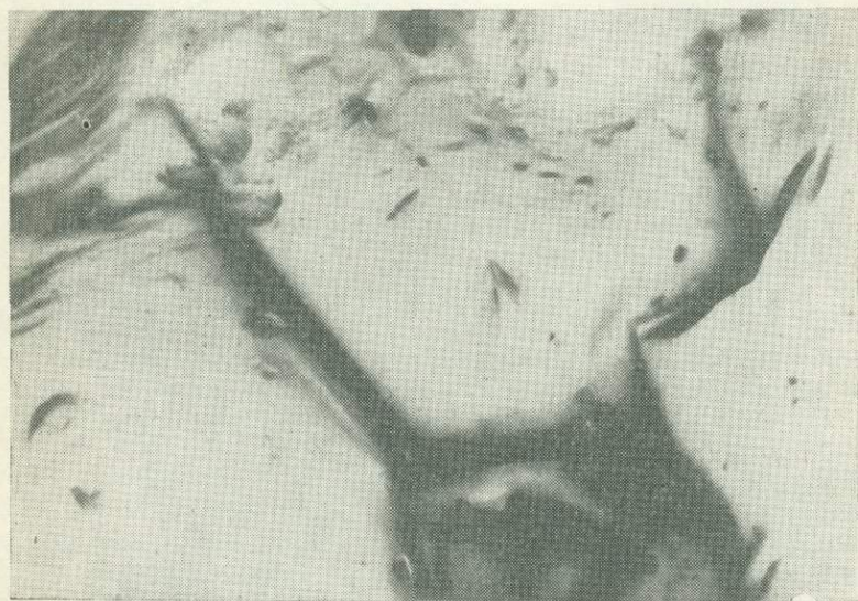
Рис. 5. Следы деформаций чешуйчатого золота в участках стыковки разноориентированных плоскостей скольжения. Увел. 7000.
