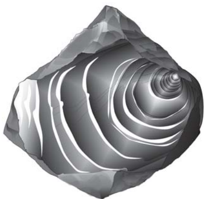
Рис. 29. Совершенная спайность в трех направлениях и ступенчатый излом галита
