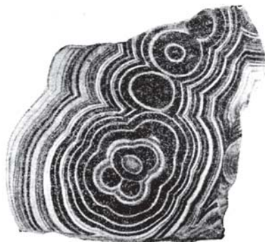
Рис. 230. Концентрически-зональное строение малахита (полированная поверхность). Гумешевское месторождение (Урал)
