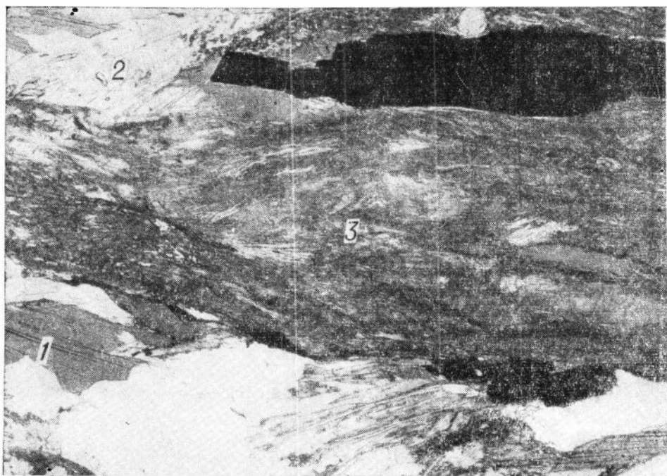
Рис. 7. Биотит (1) -мусковит (2) -силлиманитовый (3) гнейс. Черное — ильменит. Зона IV. Прозрачный шлиф без анализатора, \times 50 .
