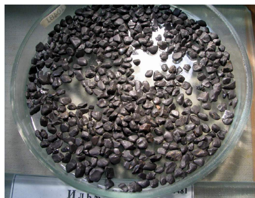
Рис. 31. Окатанные зерна ильменита из прибрежно-морской россыпи https://geo.web.ru/druza/m-ilmenit_0.htm
