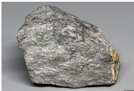
Рис. 28. Сплошной агрегат антимонита с коркой желтых оксидов сурьмы (сурьмяных охр) на поверхности
