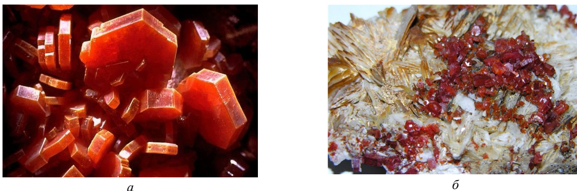
Рис. 16. Ванадинит: а – гексагональные кристаллы при увеличении; б – в виде кристаллических корочек в образце окисленной свинцовой руды http://www.jewel.ru/stone/kamen_vanadinit.html
