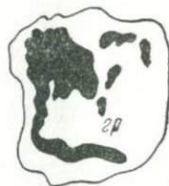
Рис. 20. Коррозионная структура замещения пластинчатого волластонита галенитом и сфалеритом. Месторождение Курусай II. Полированный шлиф, ув. 135.
