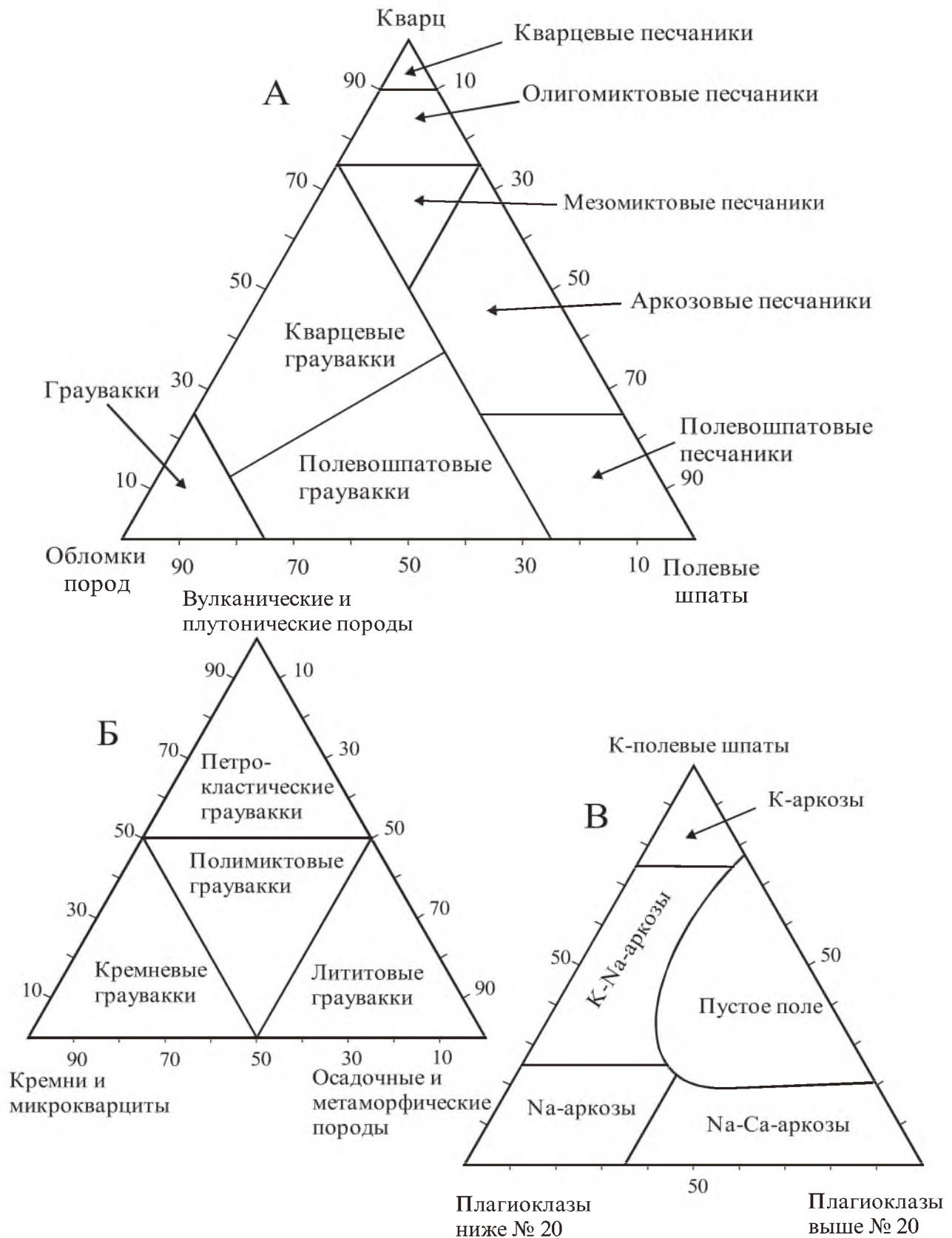
Рис. 2.5. Диаграммы состава песчаников (по Систематика ..., 1998): А – основная; Б – состава обломков пород; В – состава полевых шпатов
