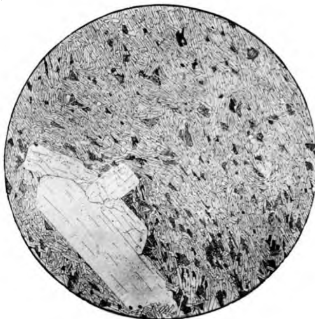
Рис. 2. 13. Трахитовый порфир с трахитовой структурой основной массы. Без анализатора. Диаметр поля зрения 4 мм. По Ю.И. Половинкиной, 1966
