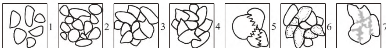
Рис. 2.2. Схематическое изображение контактов различных типов. Контакты: 1 – отсутствуют; 2 – точечные; 3 – конформные; 4 – инкорпорационные; 5 – микростилолитовые; 6 – регенерационные; 7 – корродированные
