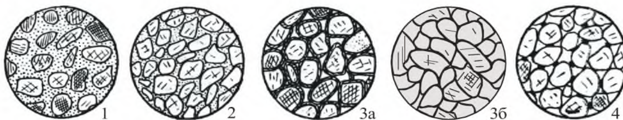
Рис. 2.3. Типы цемента в обломочных породах: 1 – базальный; 2 – поровый; 3а и 3б – пленочный; 4 – контактовый
