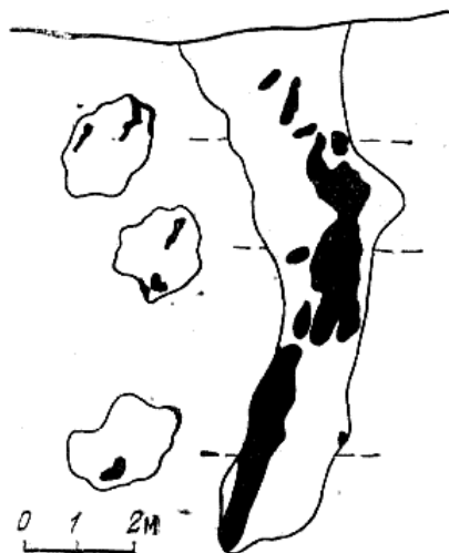
Рис. 3.3. Формы платиноносных гнезд хромистого железняка в проекции на вертикальную плоскость. Слева поперечные сечения этих гнезд (по А.Г. Бетехтину)
