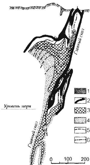
Рис. 3.3. Схематический разрез месторождения Брокен-Хилл: 1 - верхний горизонт цинковых жил (№ 1); 2 - среднее рудное тело (№ 2); 3 - нижнее рудное тело (№ 3); 4 - вкрапленное оруденение; 5 - оси синклиналей второго порядка; 6 - оси антиклиналей второго порядка
