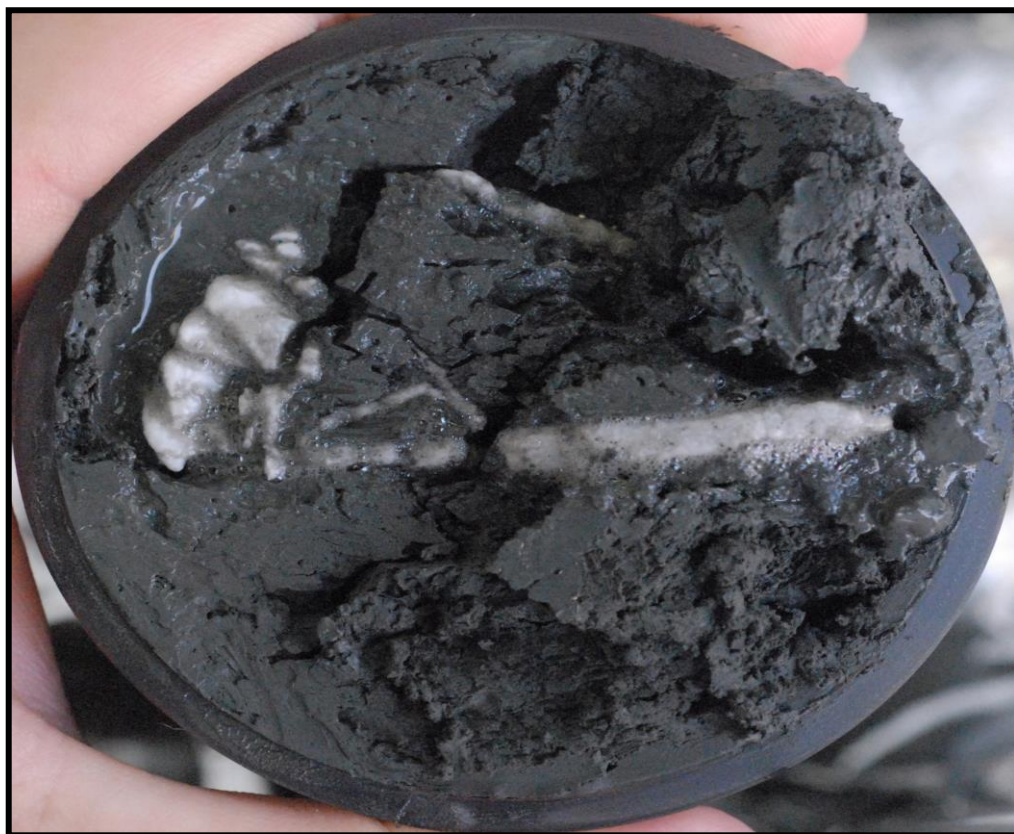
Рисунок 6.12 – Вид керна со скважины Mount Elbert с газогидратными включениями
