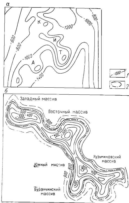
Рис. 12. Схема Ишимбаевского месторождения нефти (Башкирская АССР): а — положение в региональном плане [26]. Месторождения: К — Кусялиуловское, И — Ишимбаевское, Т — Термень-Елгинское, А — Аллакаевское; б — соотношение структурного плана и контура нефтеносности [31]. 1 — изогипсы по поверхности сакмарско-артинских отложений; 2 — контур нефтеносности
