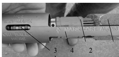
Рис. 7.9. Керноскоп Ezy-Mark в момент определения параметров керноскопа:
