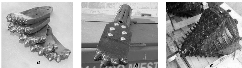
Рис. 8.2. Инструмент для горизонтального бурения фирмы Tracto Technik : а – съемные направляющие лопатки; б – буровая головка с лопаткой; в – расширитель
