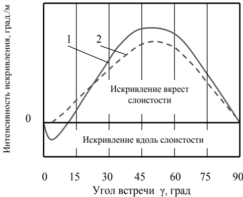
Рис. 2. 49. Зависимость интенсивности искривления скважин в анизотропных породах от угла встречи со слоистостью, сланцеватостью
