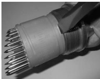
Рис. 7.10. Механическая печать керноскопа Verti-ori
