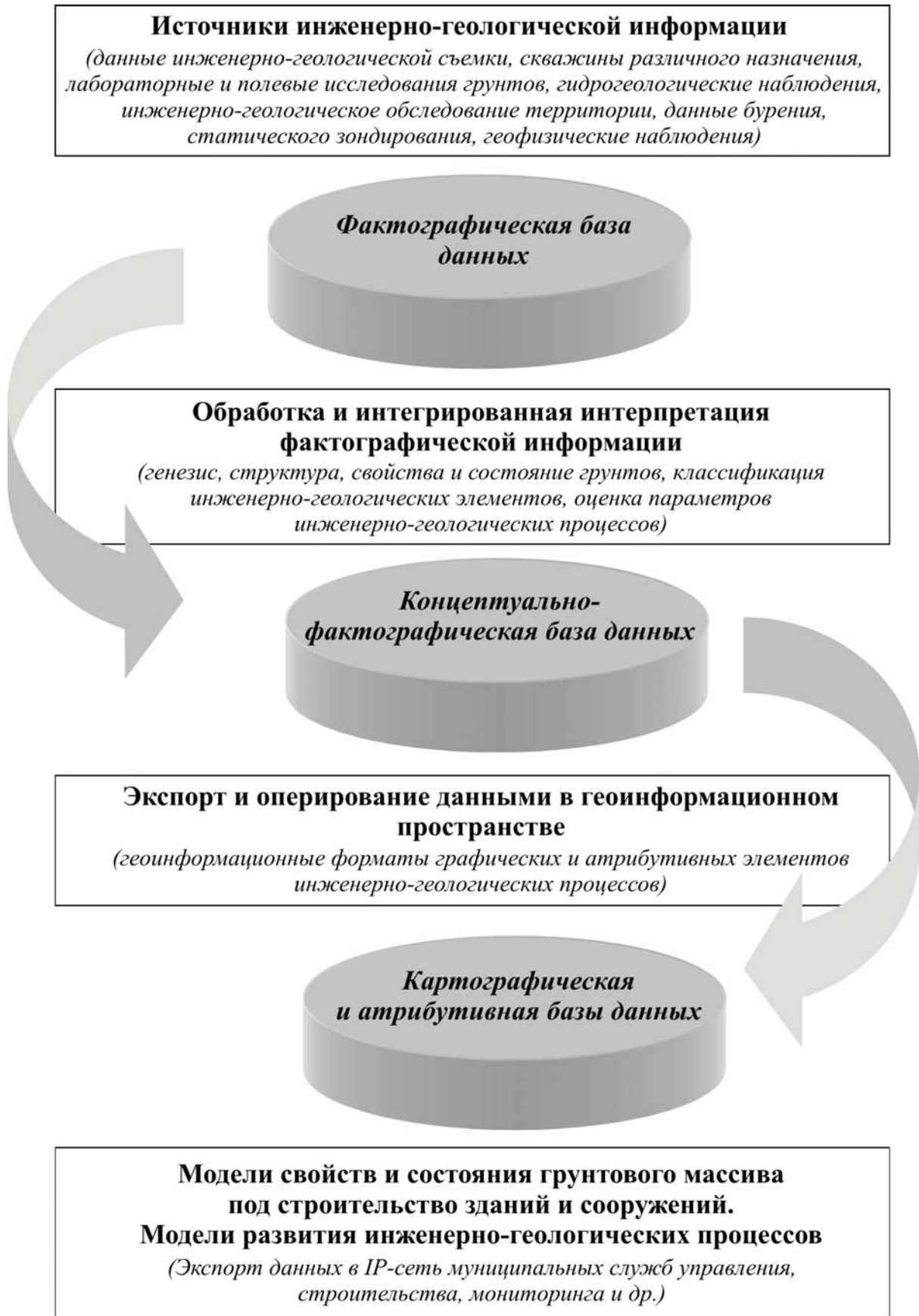
Рис. 4. Функциональная схема постоянно действующей инженерно-геологической модели ИГУ МПИ
