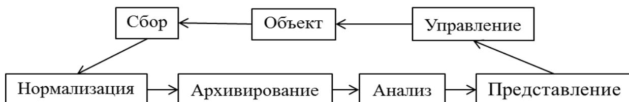
Рисунок 2. Перспективная логически замкнутая структура мониторинга ГПА
