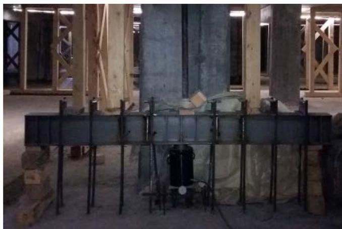
Рисунок 1. Схема испытательной установки
