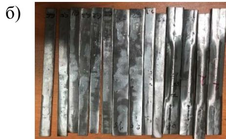
Рисунок 2. Образцы для испытаний: а) образец из цельного фрагмента сигма-профиля для испытания методом твердометрии; б) образцы стальных полос
