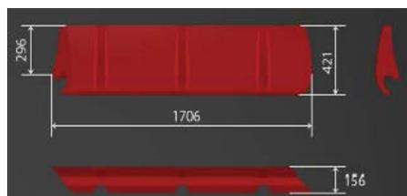
Рисунок 3. Борт составной части дорожного основания
