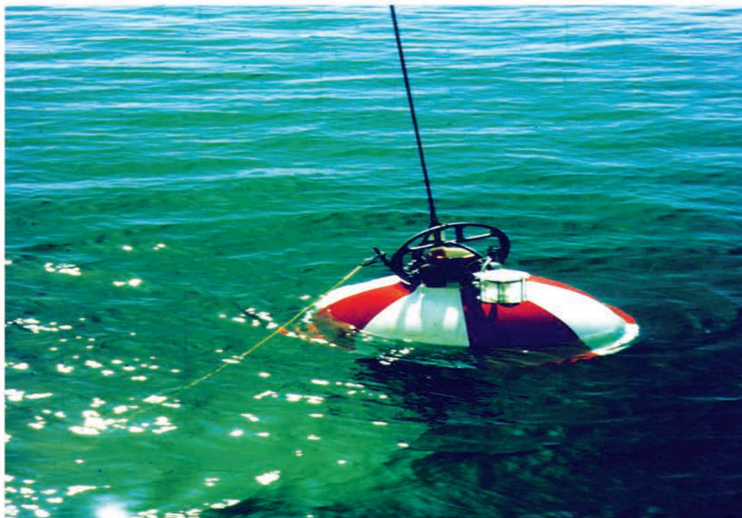
Рис. 10.5. ГДАС серии «Монитор» с комплектом гидрофизических датчиков после всплытия на поверхность моря
