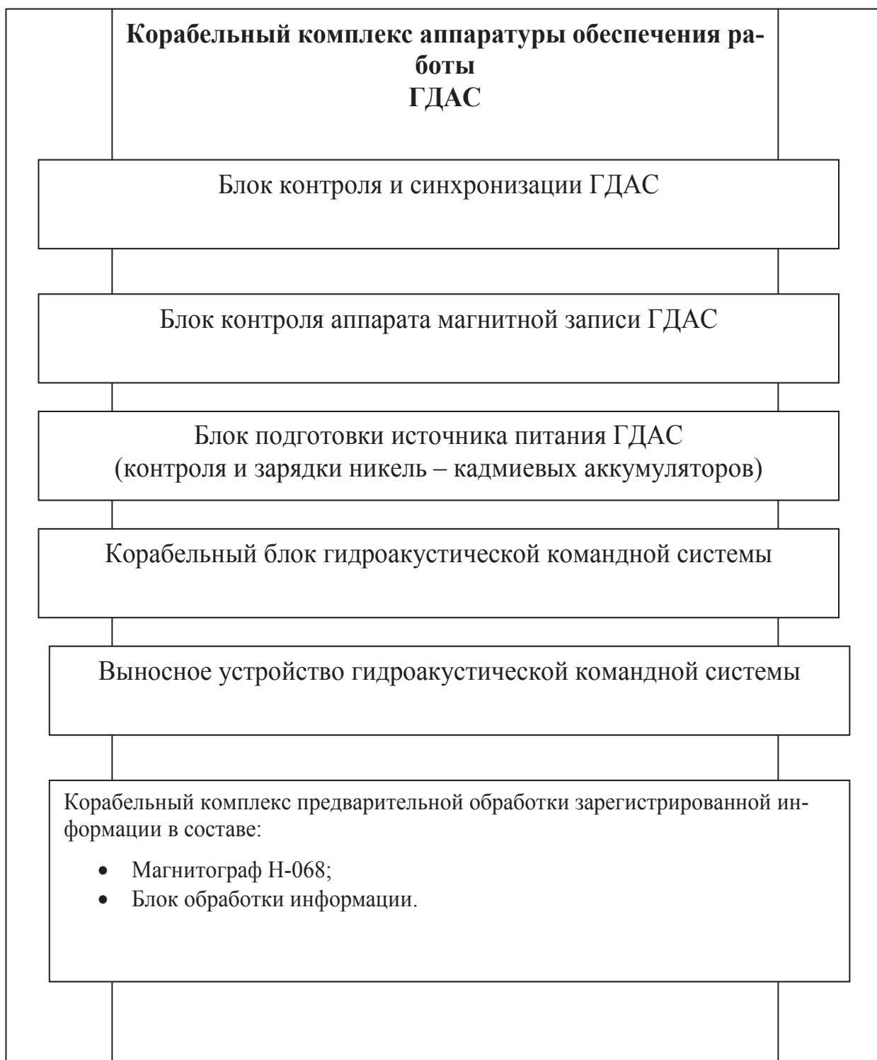
Рис. 10.2. Состав комплекса глубоководных донных станций (ГДАС) серии «Монитор»
