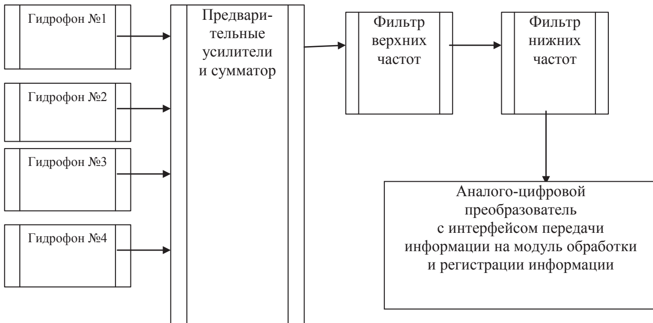
Рис. 10.11. Структурная схема приемного усилителя гидроакустических станций серии «Магна»
