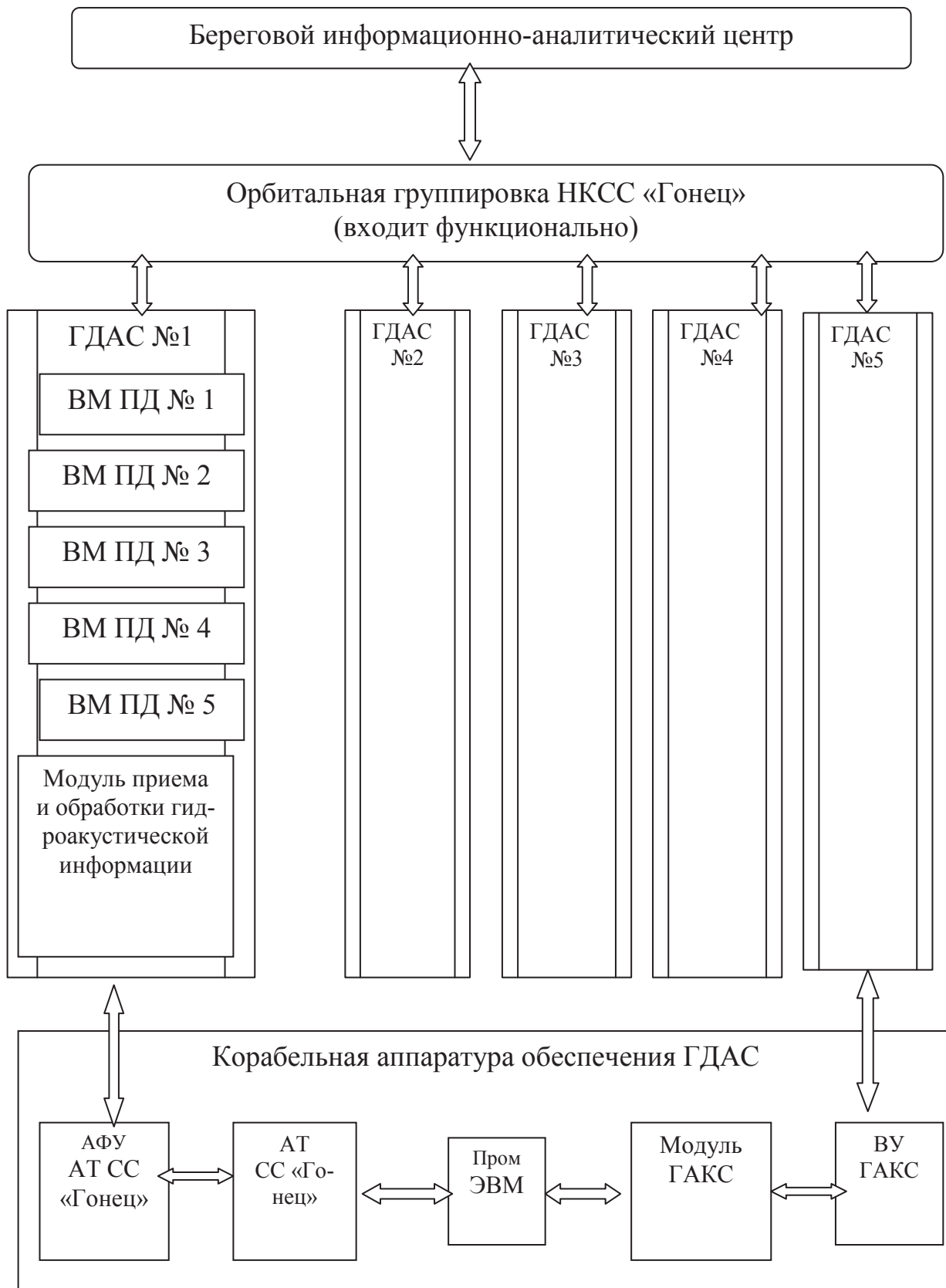
Рис. 10.6. Структурная схема комплекта ГДАС серии «Магна» с подсистемой передачи информации с поверхности моря на обеспечивающий корабль или на береговой информационный центр
