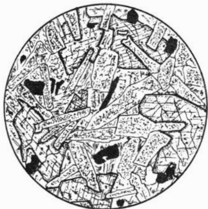
Рис. 4. Диабаз под микроскопом, d = 3,1 мм (пояснения в тексте)
