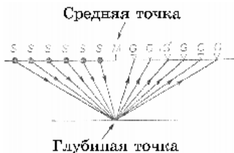
Рис.1-41 Обработка сейсмических данных выполняется в координатах “средняя точка - вынос” ( y, h ). Показанные лучи ассоциируются с одной выборкой ОСТ. Эта выборка идентична выборке ОГТ, если глубинная точка находится на горизонтальной плоской отражающей поверхности, а расположенная над ней среда является горизонтально-слоистой.
