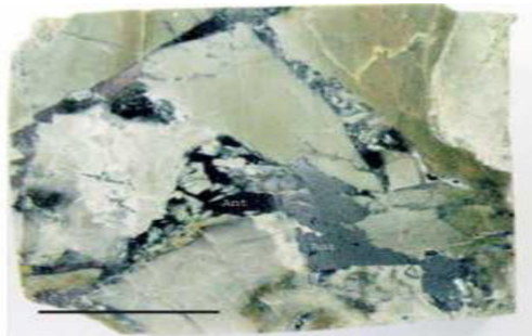
Рис. 4.3. Мелковкрапленый антимонит в кварц-антимонитовой прожилке, аншлиф
