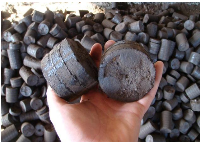
Рисунок 4.15 – Торфяные топливные брикеты (а), гранулы (б), полученные путем дробления брикетов
