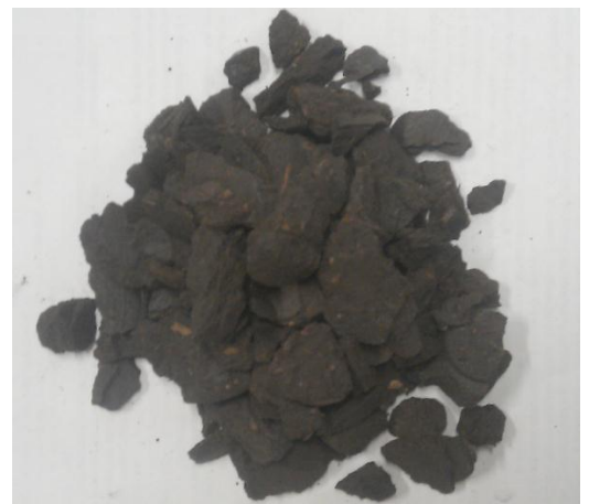
Рисунок 4.15 – Торфяные топливные брикеты (а), гранулы (б), полученные путем дробления брикетов
