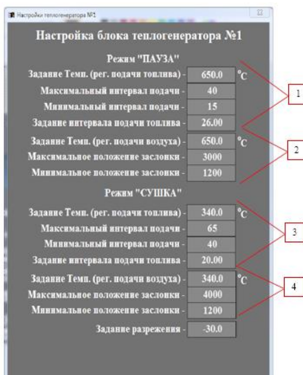
Рисунок 4.7 – Оперативные настройки теплогенератора
