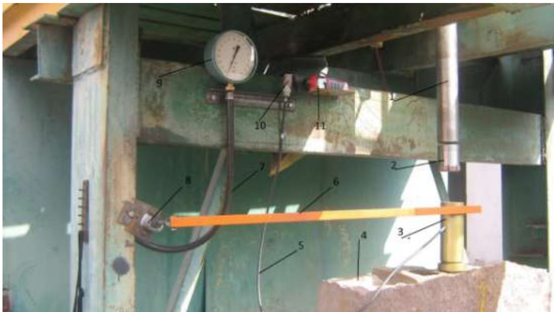
Рис. 4.4 – Вид монтажа стенда для измерения крутящего момента и частоты вращения ротора гидродвигателя на буровом экспериментальном стенде: 1 - забойный двигатель, 2 - породоразрушающий инструмент, 3 - упор, 4- блок горных пород, 5 - трос, 6 - рычаг, 7 - шланг высокого давления, 8 - цилиндр, 9 - манометр, 10 - стаканчик со отражающей полоской, 11 - тахометр.
