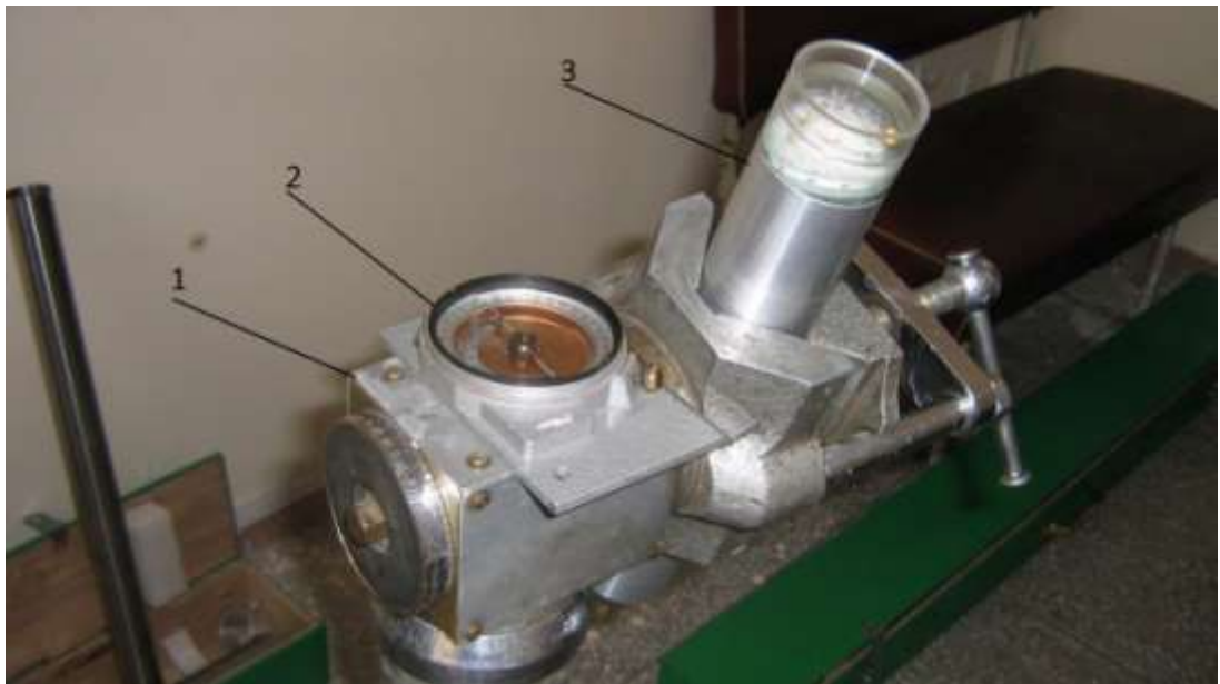
Рис. 4.2 –Лабораторно-стендовые испытания измерительной головки инклинометра:
