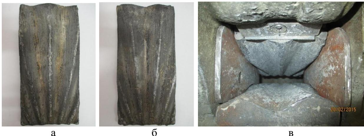
Рис. 12. Дробящие плиты с переменными рифлениями: *a* – подвижная плита; *б* – неподвижная плита; *в* – установленные дробящие плиты
