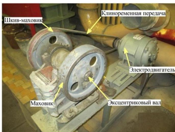
Рис. 17. Щековая дробилка типа ДЩ 100-60
