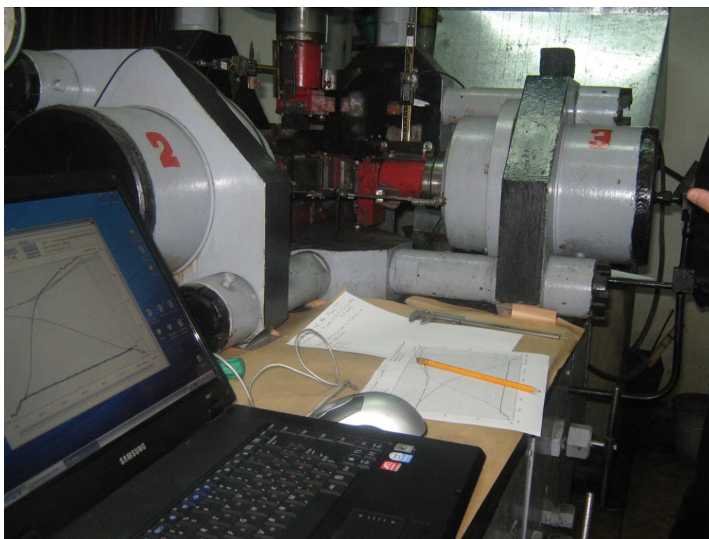
Рисунок 3.1 – Пресс трехосного сжатия
