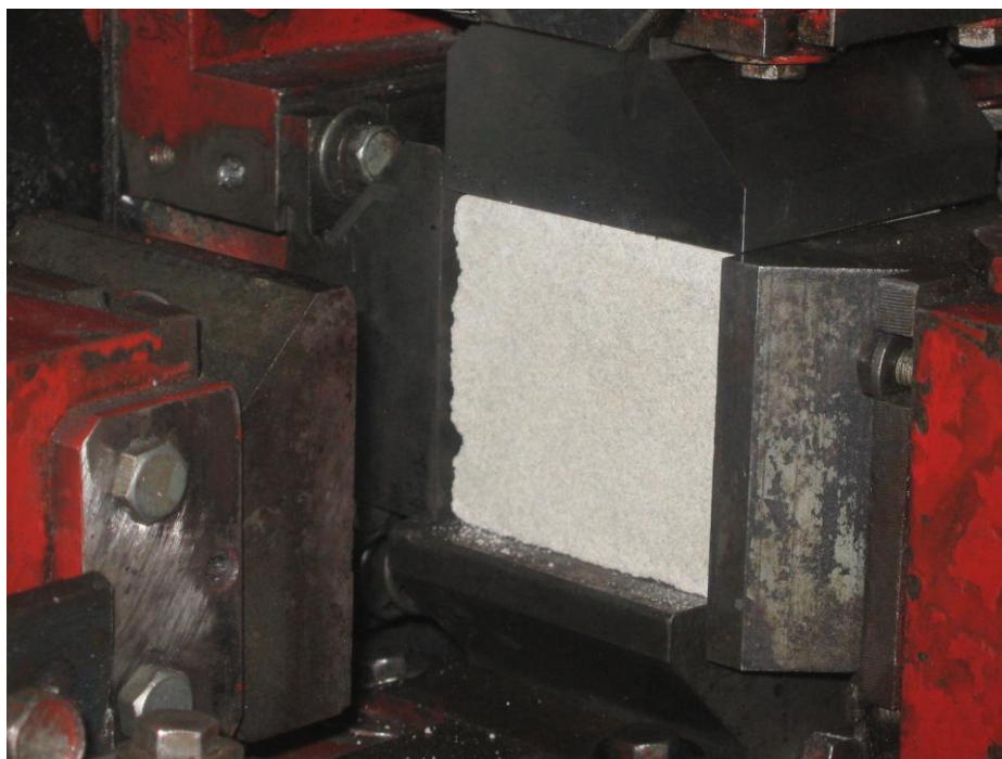
Рисунок 3.2 – Испытание образца без трещин
